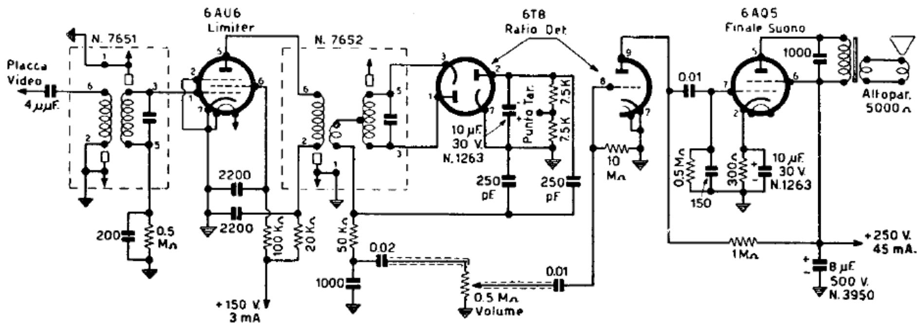
Schema elettrico completo dell'unità suono N. 7811. Grazie al sistema «intercarrier» questa sezione del televisore viene ridotta unicamente a questa semplice unità; si hanno così, oltre ad una semplificazione notevole, i diversi vantaggi di cui è detto nel testo.
